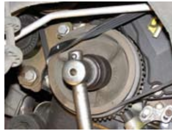
Zonder installatietool kan men de riem beschadigen. Zonder installatietool kantelt de riem. Hierdoor kunnen de ribben beschadigd worden. (foto's Gates)
