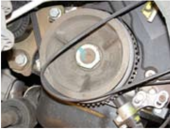
Zonder installatietool kan men de riem beschadigen. Zonder installatietool kantelt de riem. Hierdoor kunnen de ribben beschadigd worden. (foto's Gates)
