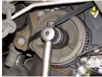
Zonder installatietool kan men de riem beschadigen. Zonder installatietool kantelt de riem. Hierdoor kunnen de ribben beschadigd worden. (foto's Gates)
