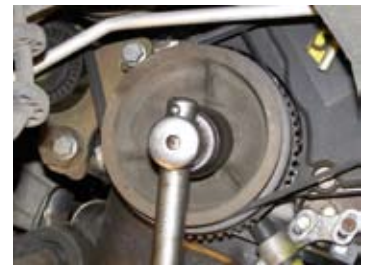
Zonder installatietool kan men de riem beschadigen. Zonder installatietool kantelt de riem. Hierdoor kunnen de ribben beschadigd worden. (foto's Gates)
